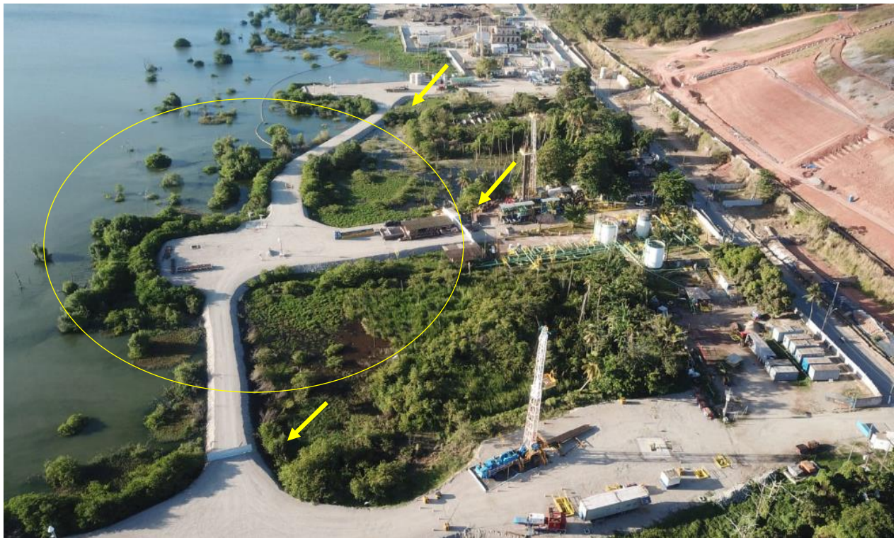
Figura 17: Área de segurança estabelecida pelo IfG para a cavidade M#18 (círculo amarelo) e barreiras físicas implantadas para isolamento desta área (setas amarelas).
