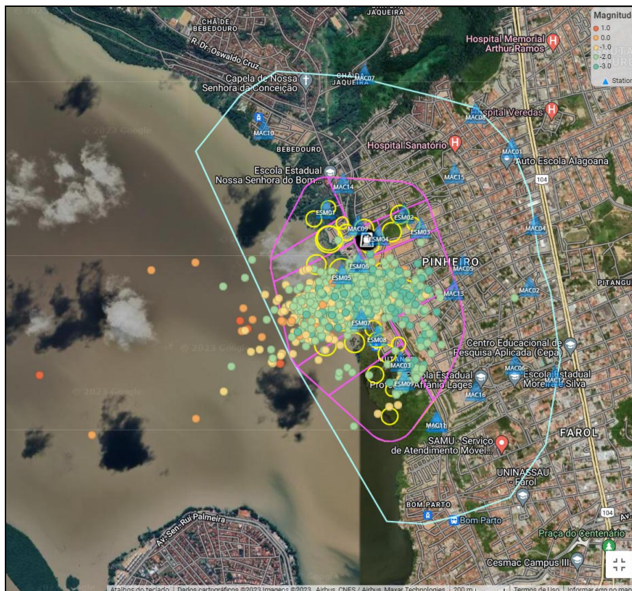
Figura 6: Projeção horizontal da localização epicentral dos microssismos. A linha violeta indica os setores e os limites da área de projeção das cavidades com seus raios de segurança, e a linha azul indica a área foco de monitoramento microssísmico.
