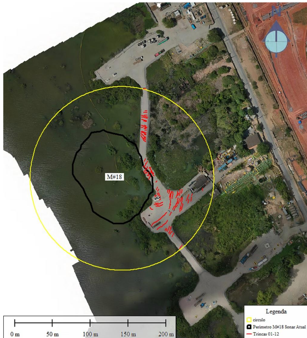
Figura 19: Mapeamento das trincas visíveis e limites da área de segurança da cavidade M#18 estabelecida pelo IfG, baseado na qual foram instaladas as barreiras físicas.
