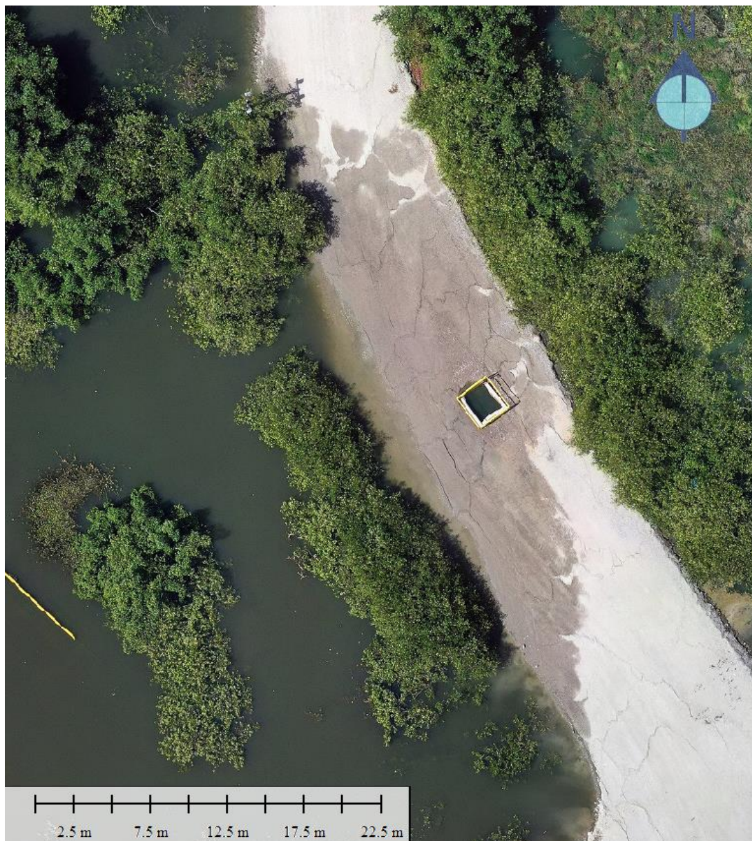
Figura 13: Trincas no aterro recentemente realizado na área das operações de fechamento, próximo à área acima da cavidade M#18. A caixa corresponde à cabeça do poço original da cavidade M#18 (18D). Notar que a área apresenta umidade devido à aproximação do nível do aterro com a lâmina d'água da lagoa.
